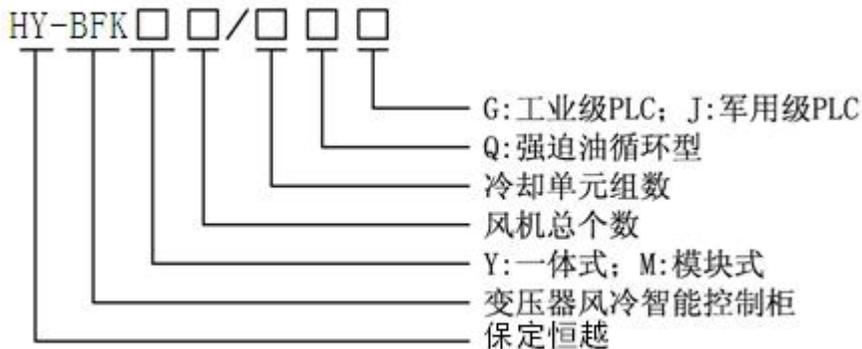
型号举例: HY-BFKY12/4QJ则为保定市恒越电气科技有限公司生产的: 军用PLC型12个风机4组冷却器强油循环一体式风冷智能控制柜
